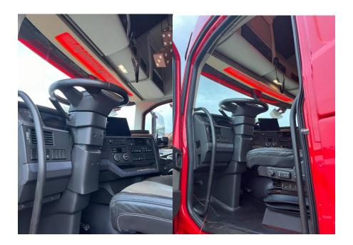
Für den Einbau muss die originale Sonnenblende entfernt werden. Die neue Sonnenblende wird von hinten durch die originale Sonnenblende verschraubt. Dafür muss diese abgebaut werden, um zu gewährleisten, dass keine Kabel oder Bauteile beschädigt werden. Nach diesem Schritt die originale Sonnenblende mit der neuen wieder in den LKW verbauen.
