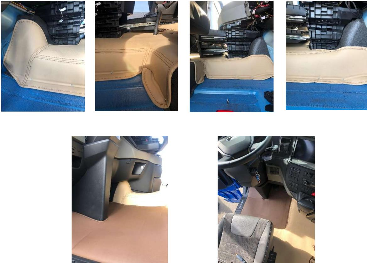
Um die Tunnel einzubauen, müssen sie das Plastik vom unteren Teil des Armaturenbretts abbauen, daraufhin werden die Tunnel reingelegt, wir empfehlen die Seiten des Tunnels mit kleinen Schrauben fest zu machen, damit keine Wellen entstehen. → siehe Fotos die ausgebauten Teile werden wieder eingebaut.
